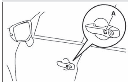
A. دکمه / شاسی قفل / باز کردن درب راننده یا سرنشین جلو
